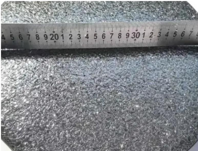
晶锭形态完美，表面微凸度精准控制在 2.4mm 以内，成功突破同一炉台多尺寸生长技术壁垒，实现了同一台设备既可稳定量产八寸碳化硅单晶，又完全具备生长十二寸碳化硅单晶的能力。
