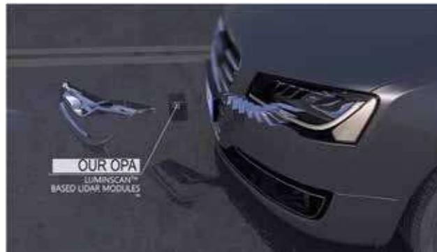
总体上，使用LuminWave的硅光OPA扫描方案可允许软件定义任意扫描区域（Region of Interest or ROI），并可配合各类飞行时间（ToF）和调频连续波（FMCW）传感器，用最低成本实现产品的高性能。
