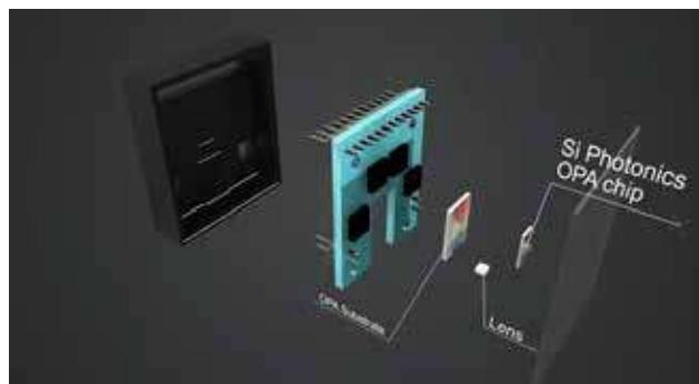
相较于上述两种激光雷达方案，基于硅光子芯片的光相控阵（OPA）方案量产的一致性高，可靠性好，成本更低，被认为有潜力成为统治固态激光雷达的方案。
