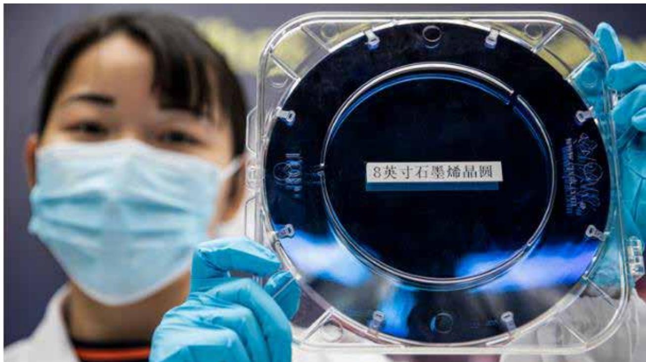
上海科学家让石墨烯从用胶带剥离出几微米的样品，升级为可以规模化生产的8英寸晶圆。
