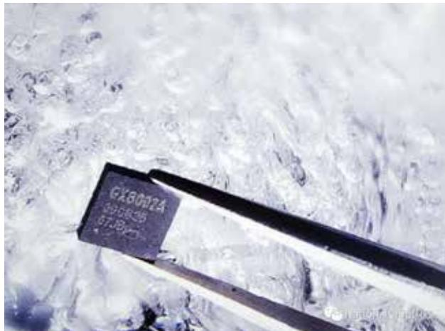
同时在封装设计上，GX8002采用的是SIP立体封装技术，将Flash叠封在内。首推的封装为QFN20，3mmx3mm，非常便于生成和使用。在Q3国芯还将推出更小的WLCSP封装，尺寸可达1.4mmx2.4mm，满足更加精密产品的需求。
