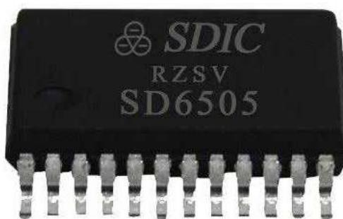
晶华微自成立以来，致力于高性能、高品质混合信号集成电路设计及销售，并为用户提供一站式产品化应用方案设计。SD6505是晶华微推出的一款集模拟信号处理单元、LED驱动和人体阻抗测量模块于一体的高性能模拟前端芯片，其中模拟信号处理单元包括可编程低噪声高输入阻抗前置放大器和24位高精度 $\Sigma-\Delta$  ADC；LED驱动电路最多可驱动56个共阴极LED，最大驱动电流14mA，LED驱动波形占空比可选；人体阻抗测量模块内置正弦波发生器和整流电路，将人体阻抗转化为电压信号通过模拟信号处理单元进行测量，可以支持四电极、多频率人体生物电阻抗测量和分析。与桥式压力传感器配合典型用于体脂秤和人体成分分析仪等应用。
